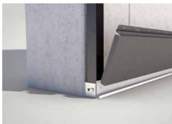
4 _ Fissaggio del primo pannello alla base della facciata / Fixing of the first panel to the base of the facade
